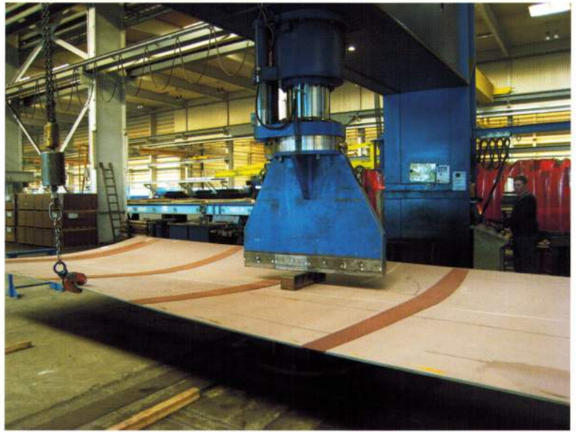
Bild 4 Für kleinere Radien erhält die Schiffsbaupresse statt der Pressrolle ein Biegeschwert.
