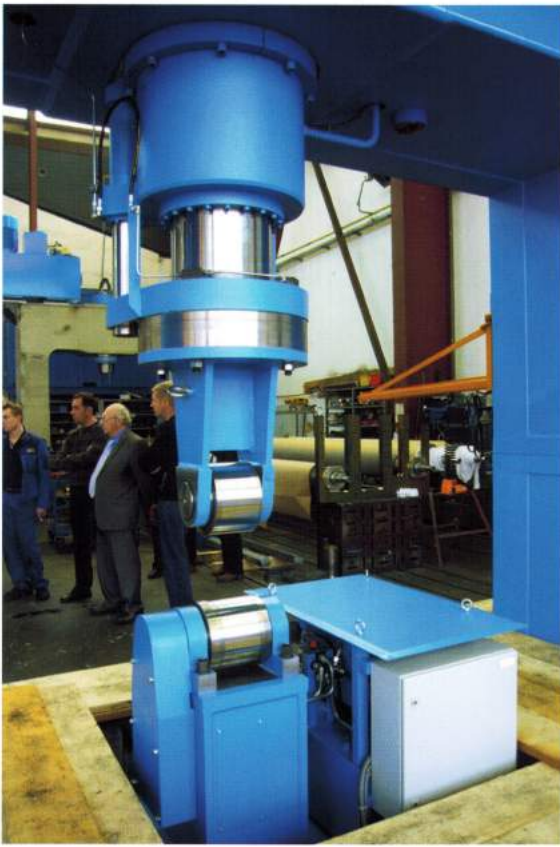
Bild 3 Rollenpresseinheit mit oberer Pressrolle und unterem Rollenaggregat.
