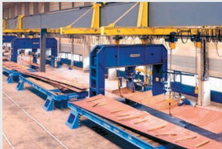
Anordnung von mehreren Schiffsbaupressen
