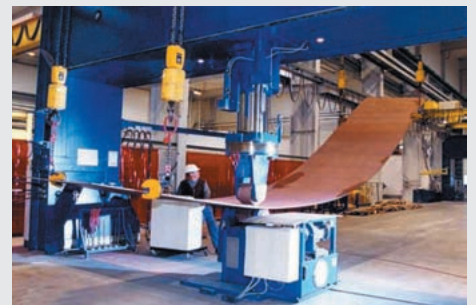
Schiffsbaupresse mit eingebauter Rollenpresseinheit
